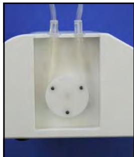
Die unsterile Assistenz legt den verstärkten Teil des Kühlschlauchsystems nach Öffnung des Rotorgehäuses (12) unter leichter Spannung um den Rotor und befestigt ihn in der Schlitzhalterung. Danach steckt sie die Einstichkanüle der Tropfammer in den Behälter mit der Kühlflüssigkeit.
