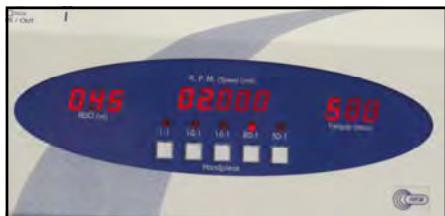
**Am Display (6) wird die aktuelle Drehzahl angezeigt. Bei ruhendem Instrument wird automatisch die eingestellte Maximaldrehzahl angezeigt.**
