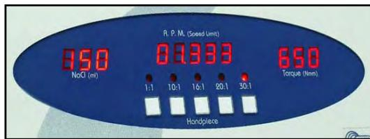
**Entsprechend dem gewählten Winkelstück wird die Untersetzung eingestellt (8). Es stehen folgende Möglichkeiten zur Verfügung:**
